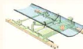
ベルトコンベヤで連続輸送される原料および製品の受け渡しの際に計量。
