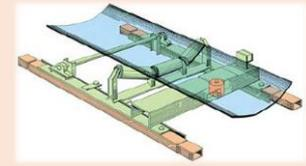
ベルトコンベヤで連続輸送される原料および製品の受け渡しの際に計量。
