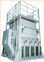
各種原料等をホッパーに流入している状態で質量を計量し、一定量（設定量）に達するとホッパーから下流へ排出。
